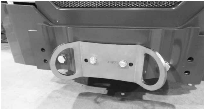
Az A418623 lekötöző tartóelem a hátsó lökhárítónál vagy az ellensúlynál van felszerelve
